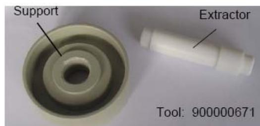
\* 步骤1: 将工具中的支座(肩部朝下)放在水平面上,然后将涡轮放在支撑上面。
